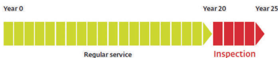
FIGURE 67 : ENTRETIEN DES ÉOLIENNES DURANT LEUR DURÉE DE VIE INITIALE ET APRÈS EXTENSION
